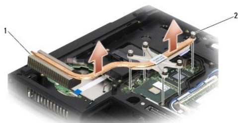
1 E5400-warmteafleiding van de processor 2 borgschroeven (5)
