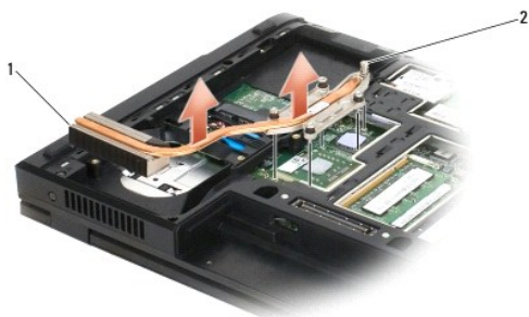
1 E5500-warmteafleiding van de processor 2 borgschroeven (5)
